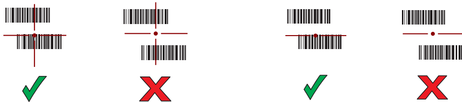
圖 29 揀選清單模式，其瞄準圖形內有多個條碼：標準和延伸範圍
