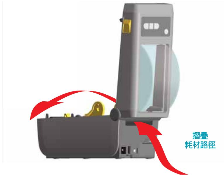
2. 以金色滾輪調整耗材導桿的停止位置。使用一張摺疊耗材來設定停止位置。將滾輪向外旋轉，可將導桿調寬。將滾輪朝您本身的方向旋轉，可將耗材導桿調窄。
