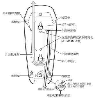
✔ 附註 架設在行動推車上時,桌面/壁掛轉換鎖鈕必須在壁掛位置 (已鎖定)。
