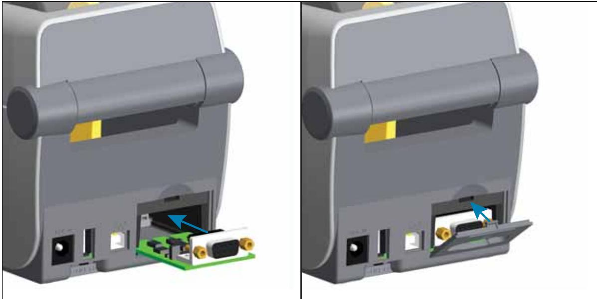
1. 移除模組檢修門後，讓序列埠模組滑入印表機。緩慢且穩定推入電路卡，直到電路卡剛好通過檢修門內側為止。
