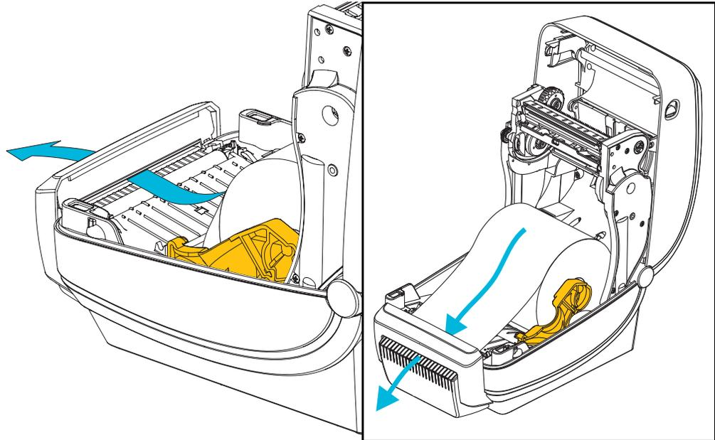
5. 將耗材推至兩根耗材導桿下方。
