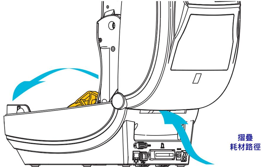
2. 以綠色滾輪調整耗材導桿的停止位置。使用一張摺疊耗材來設定停止位置。將滾輪朝您所在的方向旋轉，可將導桿調寬。將滾輪朝您所在的反方向旋轉，可將耗材導桿調窄。
