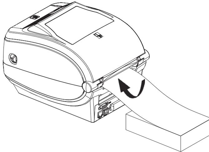
4. 將耗材穿過耗材導桿和捲筒支架。
