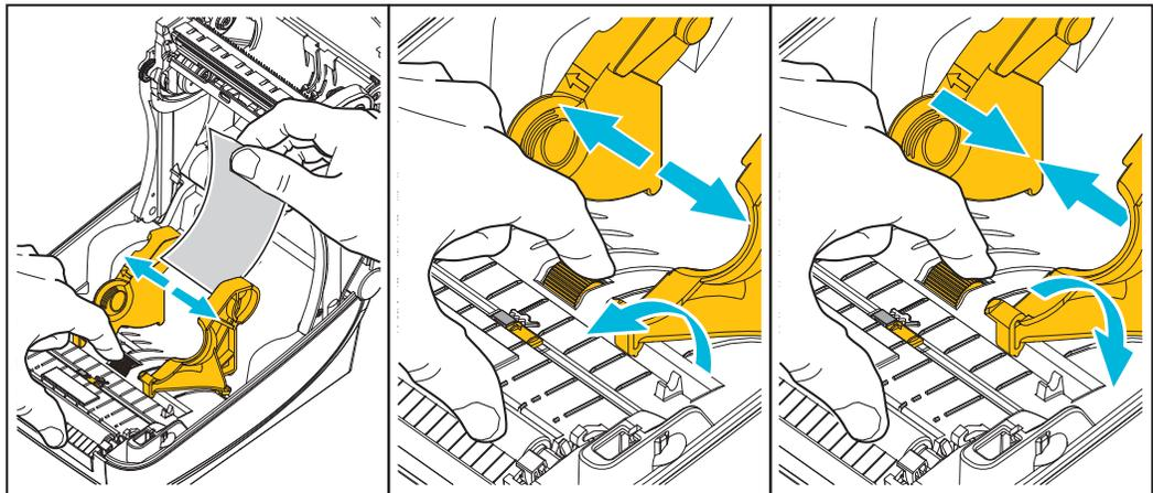
3. 將耗材透過印表機背面的槽口插入。
