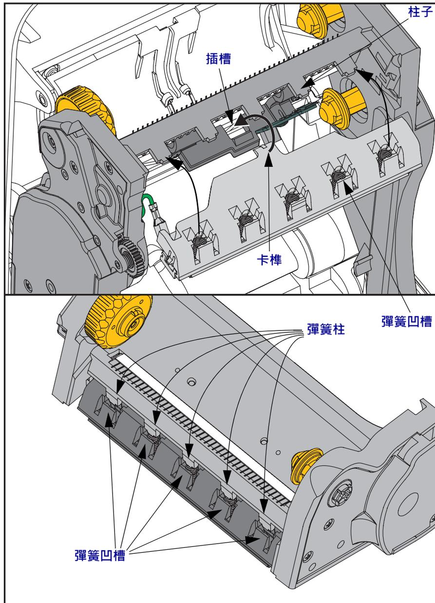
6. 將色帶導桿的左側置於色帶框架中。將色帶導桿的右側搖動至凹槽中並卡住定位。
