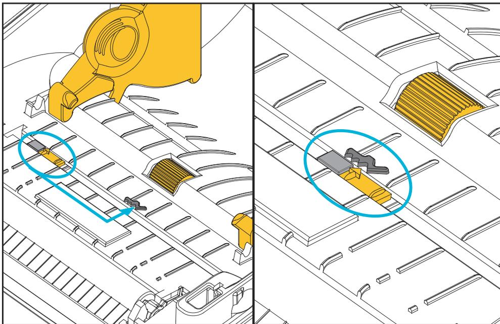
3. 開啟耗材捲筒支架。用另一隻手拉開耗材導桿，將耗材捲筒置於捲筒支架，並鬆開導桿。調整耗材捲筒的方向，使其列印面在通過滾輪（傳動）時朝上。
