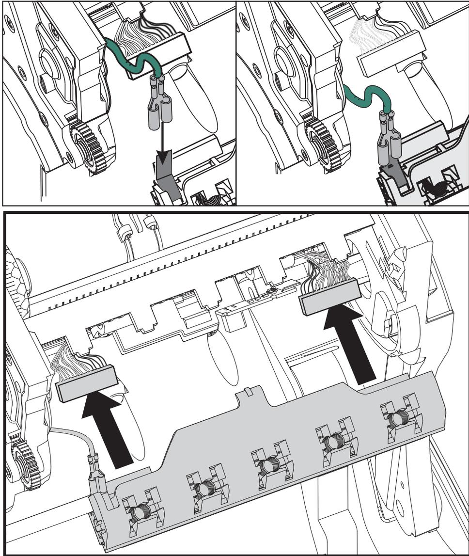
5. 將印字頭托架的卡榫插入色帶框架組件的凹槽中。將印字頭彈簧凹槽對齊五個柱子，並將印字頭卡至色帶框架中。
