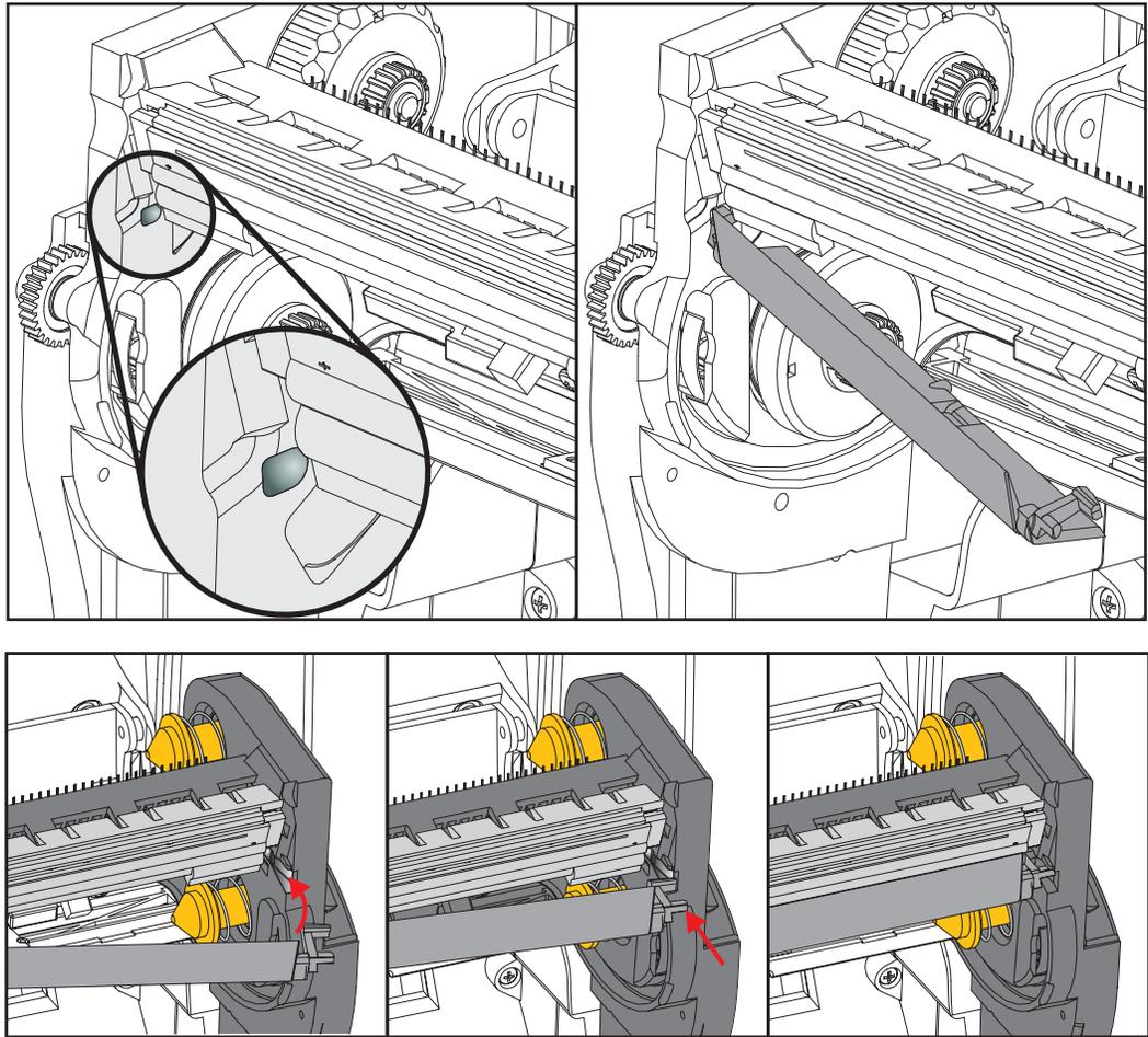
7. 確認對印字頭施力時，印字頭能夠自由地上下移動，並在放開時仍保持鎖定狀態。
