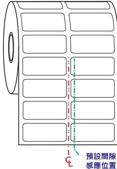
可移動感應器的膠片 ( 間隙 ) 感應僅在感應器的對齊箭頭指向對齊鍵任一位置時作用。感應器必須對齊標籤 ( 或其他耗材 ) 以感應標籤之間隙。上述範例顯示感應器在使用中央對齊定位時的所在位置。使用 2-up ( 每頁 2 張標籤 ) 標籤配置時，感應器會漏掉感應標籤，而當感應器在「預設」位置時，則可以偵測到標籤和標籤之間隙。
