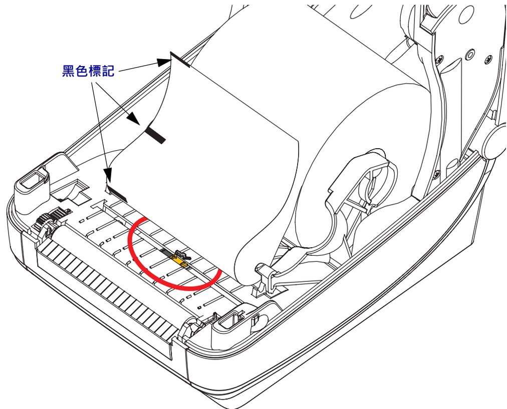
2. 從中央預設位置滑動可移動的感應器，以對齊黑色標記。可移動感應器上的箭頭應對齊黑色標記的右側邊緣。這適用於位在耗材任何一側的標記或凹洞（如左側顯示）。
