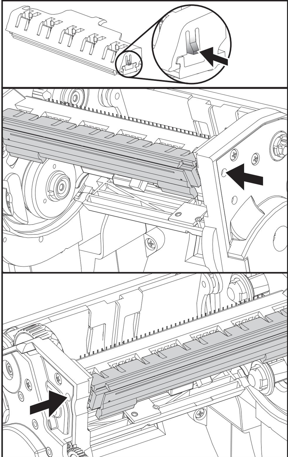
4. 用力但小心地將兩個印字頭纜線束接頭從印字頭拔下。
