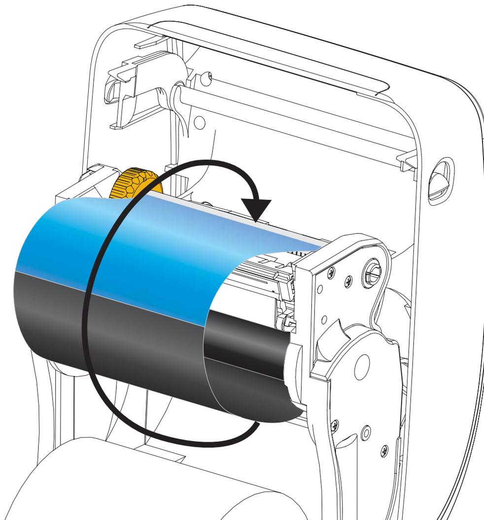
4. 朝印表機背面旋轉供應軸左側的滾輪，直到色帶橫過印字頭並拉緊為止。
