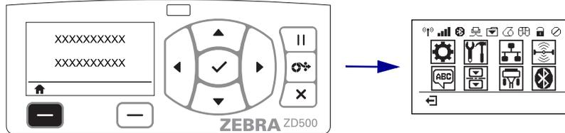
在閒置顯示 (圖 6 於第 11 頁) 中，按下**左側選取**以移至印表機的主功能表 (圖 7 於第 11 頁)。
