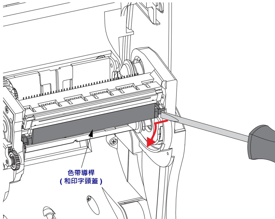
3. 使用鈍頭工具按下右側的釋放卡榫，然後再按下印字頭的左側。工具直徑可以是 0.10 至 0.15 英吋 (2.5 至 3.8 公釐)。
