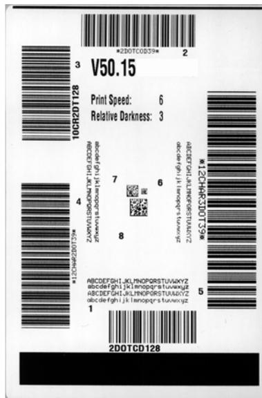
4. 請參閱圖 2 和表 6。檢查測試標籤，並決定哪一張擁有最適合您應用方式的最佳列印品質。若您有條碼讀碼機，請用讀碼機來測量碼條 / 空間，並計算列印反差。若您沒有條碼讀碼機，則使用目測或是系統掃描器，根據這個自我檢測所列印的標籤來選擇最佳的明暗度設定。
