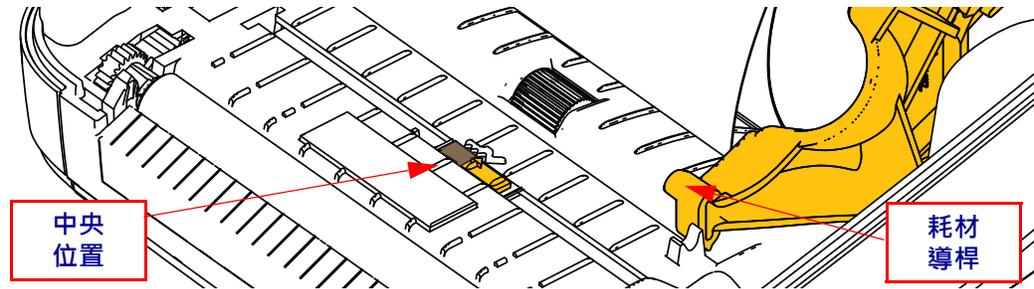
2. 移除襯墊上前 3 英吋或 80 公釐的標籤。將沒有標籤的襯墊放在滾筒 (驅動滾筒) 上，並將第一個標籤的頂端放在耗材導桿下。
