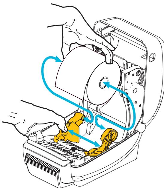
4. 將耗材穿過切割器的內部凹槽，使其延伸出印表機前方以外。確認捲筒能自由轉動。捲筒不可置於耗材盒底部。確認耗材的列印面朝上。
