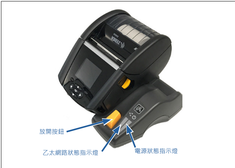
圖 7 • 單孔乙太網路托架
